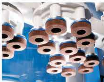
Entgratscheiben FAPI-TRIM im Einsatz auf einem Planetenkopfsystem
