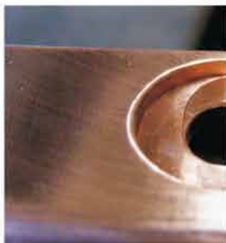
Werkstück vor und nach der Bearbeitung mit einer Entgratscheibe FAPI-M14 SAND auf einem Winkelschleifer
