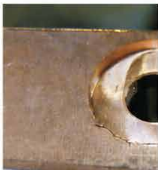
Werkstück vor und nach der Bearbeitung mit einer Entgratscheibe FAPI-M14 SAND auf einem Winkelschleifer
