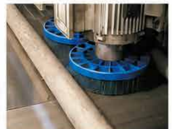
Entgratscheiben FAPI-250 im Einsatz auf einer Loewer DiscMaster 4TD
