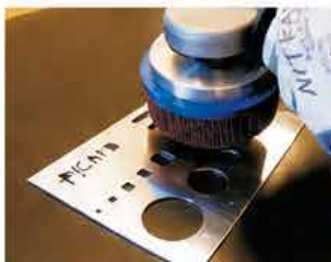
Entgratscheibe FAPI-M14 im Einsatz auf einem Winkelschleifer
