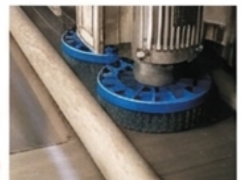
Discos de desbarbado FAPI-250 usados en una Loewer DiscMaster 4TD
