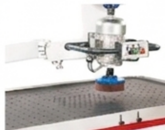
Disco de desbarbado FAPI-150 usado en una amoladora manual de Timesavers B.V.
