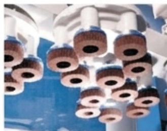
Discos de desbarbado FAPI-TRIM usados en un sistema de cabezal planetario
